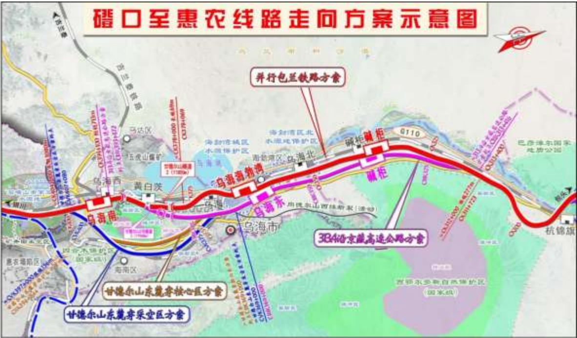
图 4.4-7 经海勃湾区北水源地、海勃湾城区水源地段线路走向方案比选示意图
