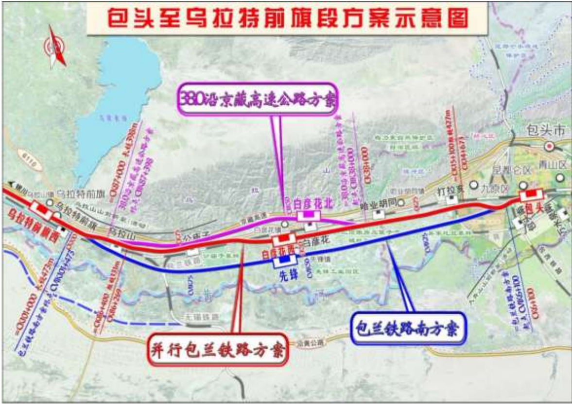
图 4.4-1 经荒粮滩汉墓群、三顶账房墓群段线路走向方案比选示意图
