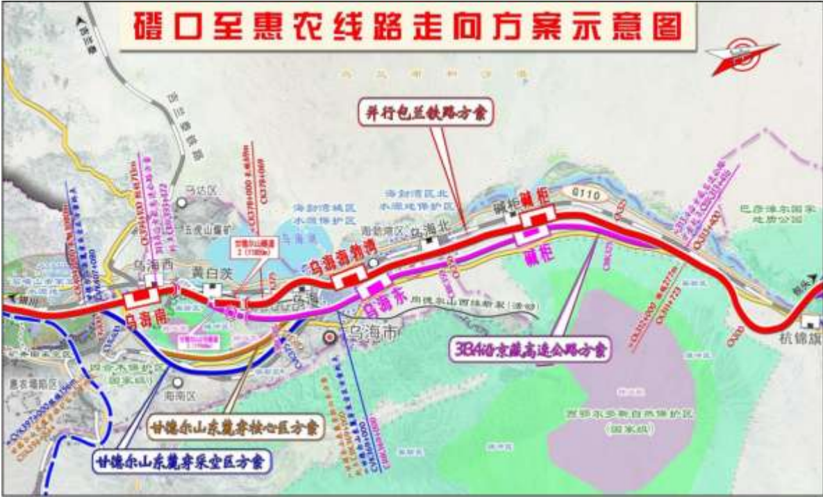
图 4.4-8 经西鄂尔多斯国家级自然保护区、秦汉长城、二道坎烽火台、秦明长城段线路走向方案比选示意图
