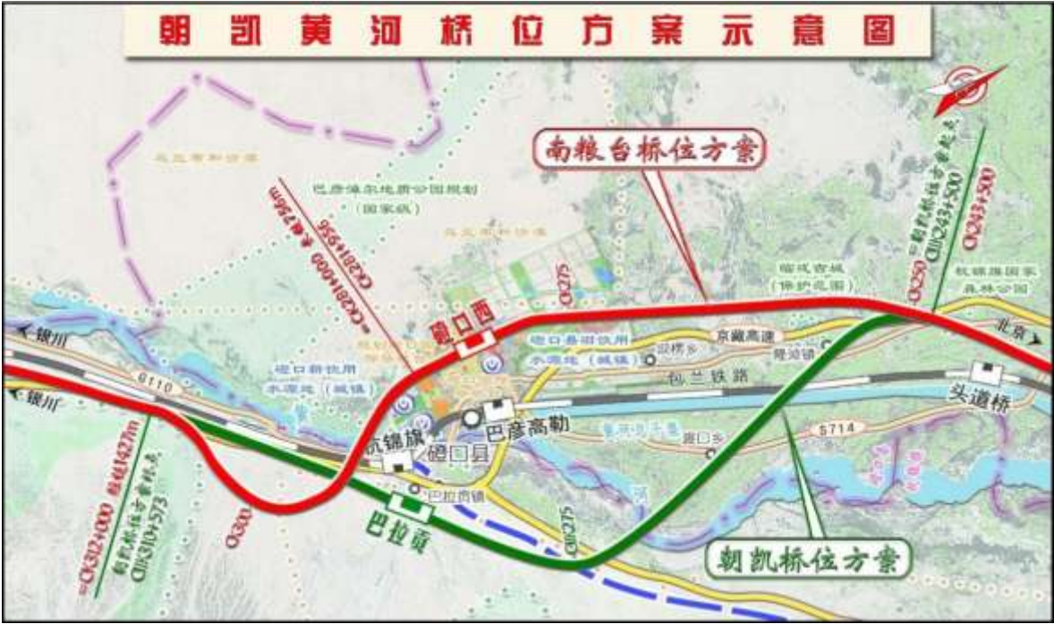
图 4.4-6-2 经内蒙古巴彦淖尔国家地质公园、黄河三盛公国家水利风景区、黄河鄂尔多斯段黄河鲶国家级水产种质资源保护区段线路走向方案比选示意图
